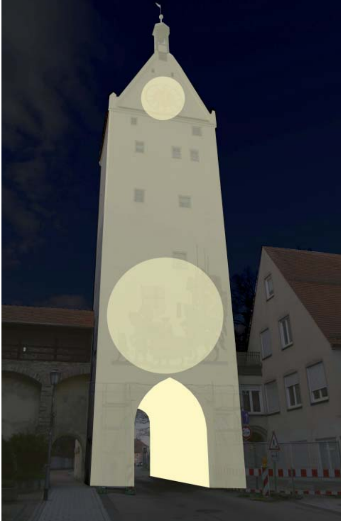
Ulmer Tor: Schema Leuchtdichten einer geplanten Anstrahlung
