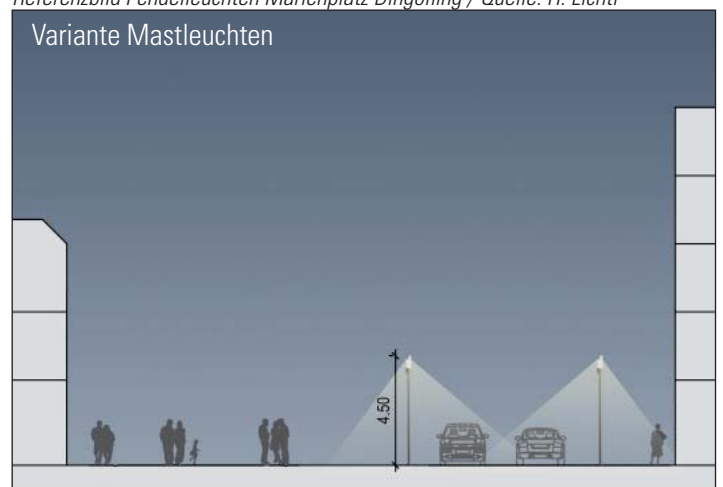
Schnitt Weinmarkt Memmingen: Variante Zylindrische Mastaufsatzleuchten
